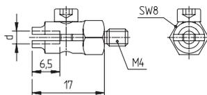
Для ультразвукового ручного инструмента UF 9000 и UF 9700 с переходником
