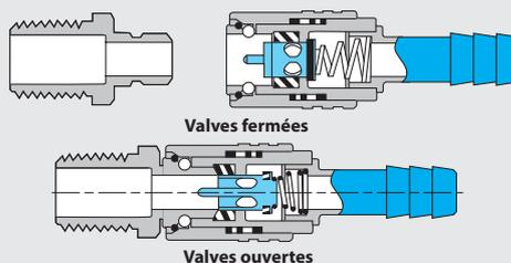
Муфты Jiffy-Tite и Jiffy-Maticc могут использоваться взаимозаменяемым образом одними и теми же штуцерами Jiffy-Tite, уже установленными в вашу пресс-форму или форму для литья под давлением.
